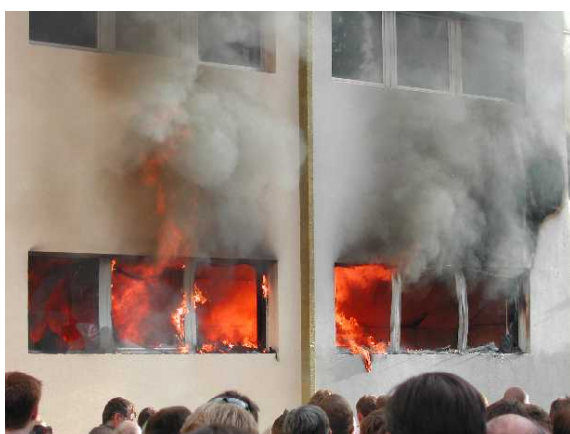
Obrázek: Fasádní požární zkoušky (po 27 minutách)
